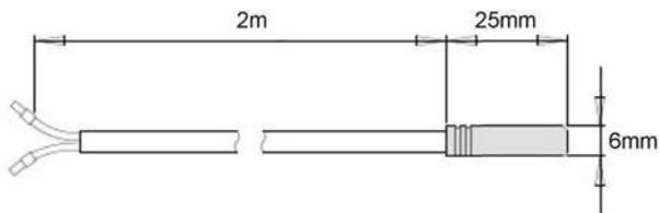
DIN Norm-NTC-Fühler mit V4A-Edelstahl-Schutzhülse in den Längen 2m...20m.
